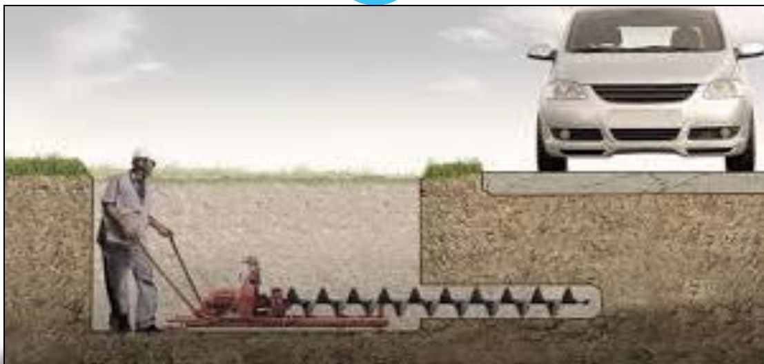
Vista de corte transversal
