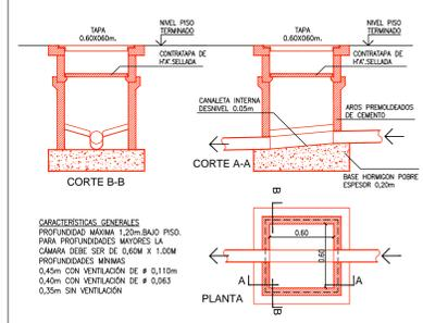
**DETALLE DE C. DESCARGA Y VENTILACION ESCALA 1:25**
