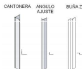
Las uniones entre placas serán tomadas con cinta de papel micro-perforada y Masilla aplicada en cuatro pasos, respetando el tiempo de secado entre cada capa de masilla, el cual dependerá del tipo de producto que se utilice. Las improntas de los tornillos T2 recibirán, al igual que los perfiles de terminación (cantoneras, ángulos de ajuste o buñas), dos manos de masilla.
