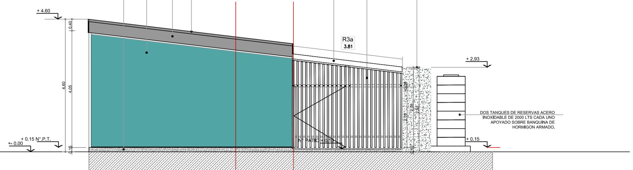
DOS TANQUES DE RESERVAS ACERO INOXIDABLE DE 2000 LTS CADA UNO APOYADO SOBRE BANQUINA DE HORMIGON ARMADO.
