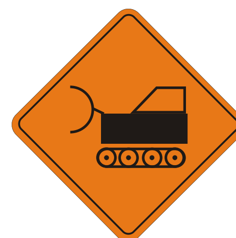
Equipo Pesado en la Vía T 7
