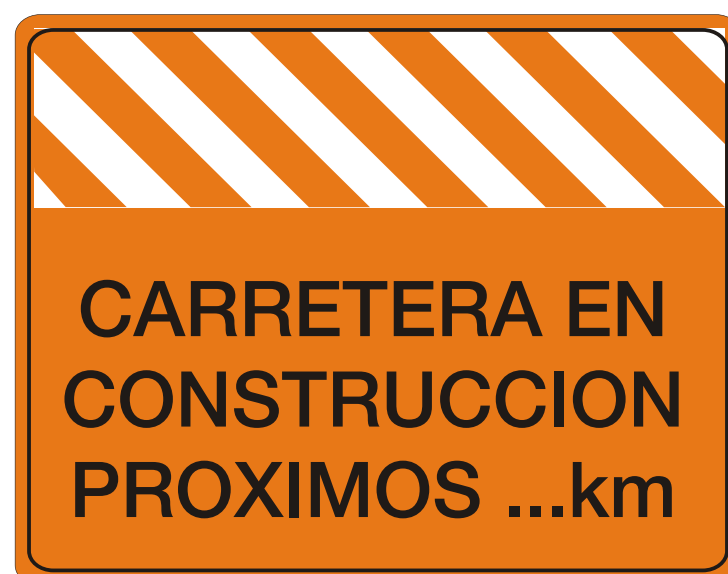
Longitud de la Construcción T 10
