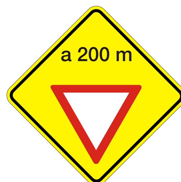
Proximidad de Señal Restrictiva (Paso) P 33
