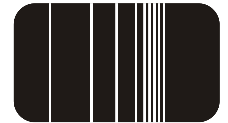
LÍNEA AUXILIARES PARA REDUCCIÓN DE VELOCIDAD
