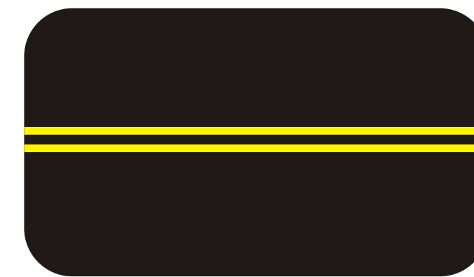
LÍNEAS DE SEPARACIÓN DE LOS SENTIDOS DE CIRCULACIÓN
