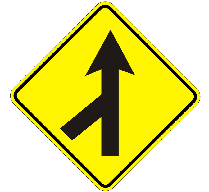
Incorporación de Tránsito Lateral P 22
