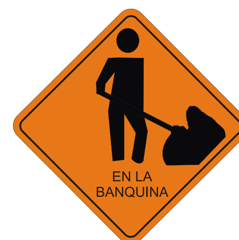
Trabajos en la Banquina T 8
