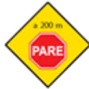
PROXIMIDAD DE SEÑAL RESTRICTIVA (pare)
